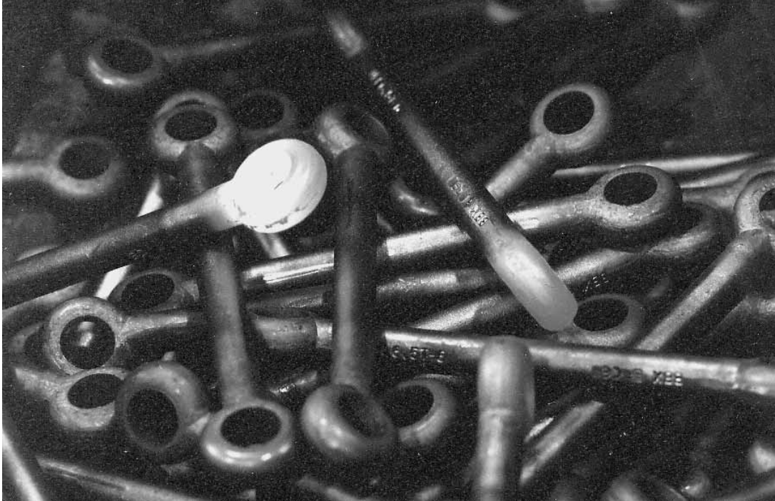
Forged, unbended shackle components – Smidde sjakler før bukking
