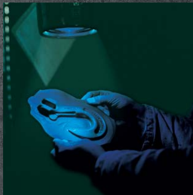
Controllo magnetoscopico. Magnaflux test. Contrôle au magnétoscope. Magnetoskop- Prüfung.
