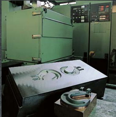
Macchina per elettroerosione. Spark-erosion machine. Machine d'électroérosion. Erodiemaschine.
