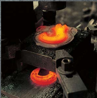
Stampaggio. Hot-forging. Matricage. Gesenschieme.
