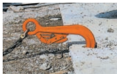
▲SH型は、ストッパーが開いた状態を維持するのでフックを外す作業が容易に出来ます。
